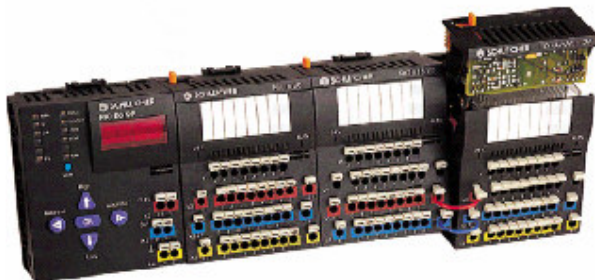
Рис.2 Контроллер Ricos BC-Ethernet PLC
